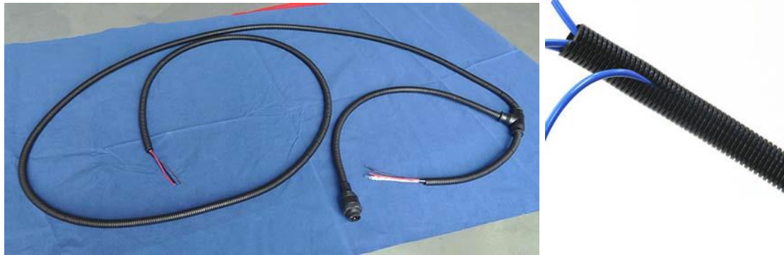
Figura B-17 – Exemplo de chicote com conector, derivação e proteção adequados (esq.) e corrugado automotivo com corte longitudinal (dir.)
