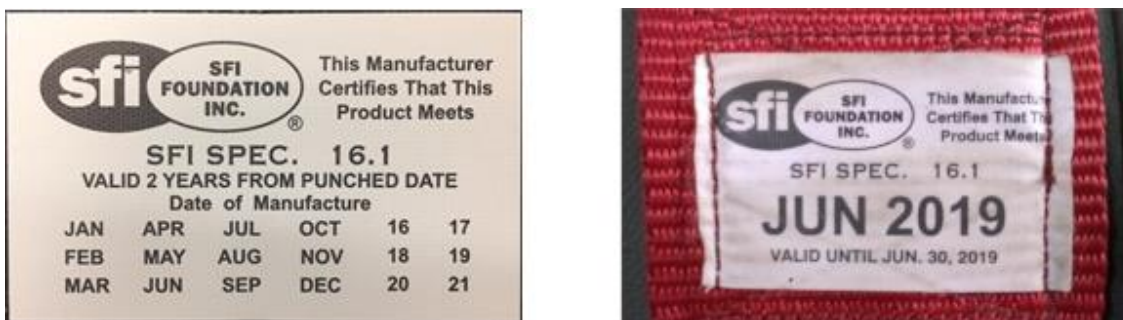
Figura B-44 – Modelos de etiqueta com data de fabricação (esq.) e data de validade (dir.) de cintos certificados na norma SFI 16.1
