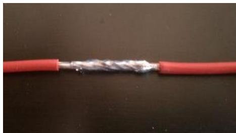
Figura B-18 – Emenda adequadamente soldada
