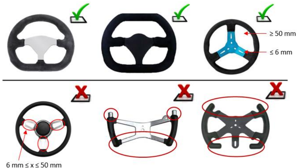
Figura B-65 – Exemplos de volantes aceitáveis (acima) e inaceitáveis (abaixo)
