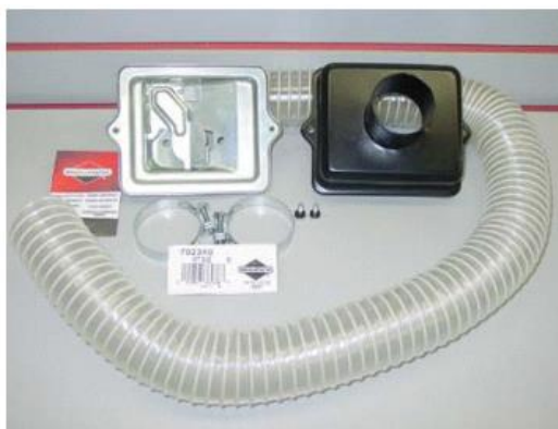
Figura B-5 – Fotos de um kit remoto original mostrando mangueira e capa do filtro
