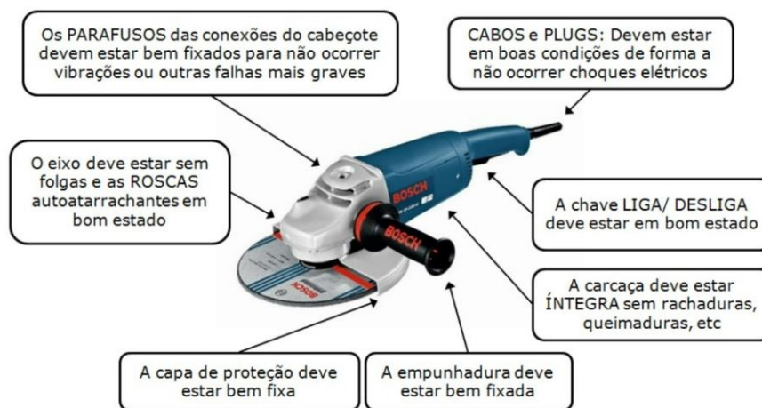
Figura C-3 – Esmerilhadeira com os requisitos de funcionamento
