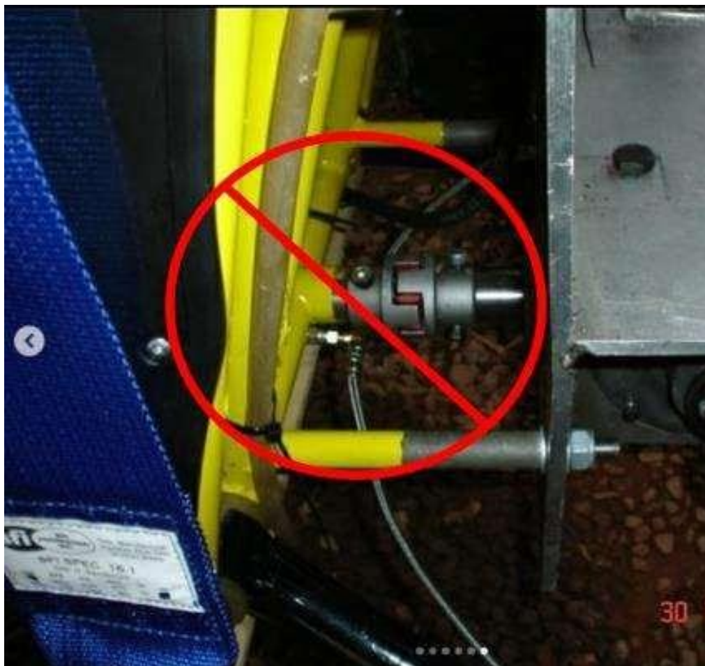
Figura 7 - Elementos de transmissão seccionando os membros da gaiola: inaceitável
