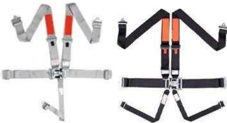
Figura 11 - Exemplos de cinto de 5 pontos (tira antissubmarina única) e cinto de 6 pontos (tira antissubmarina dupla)
