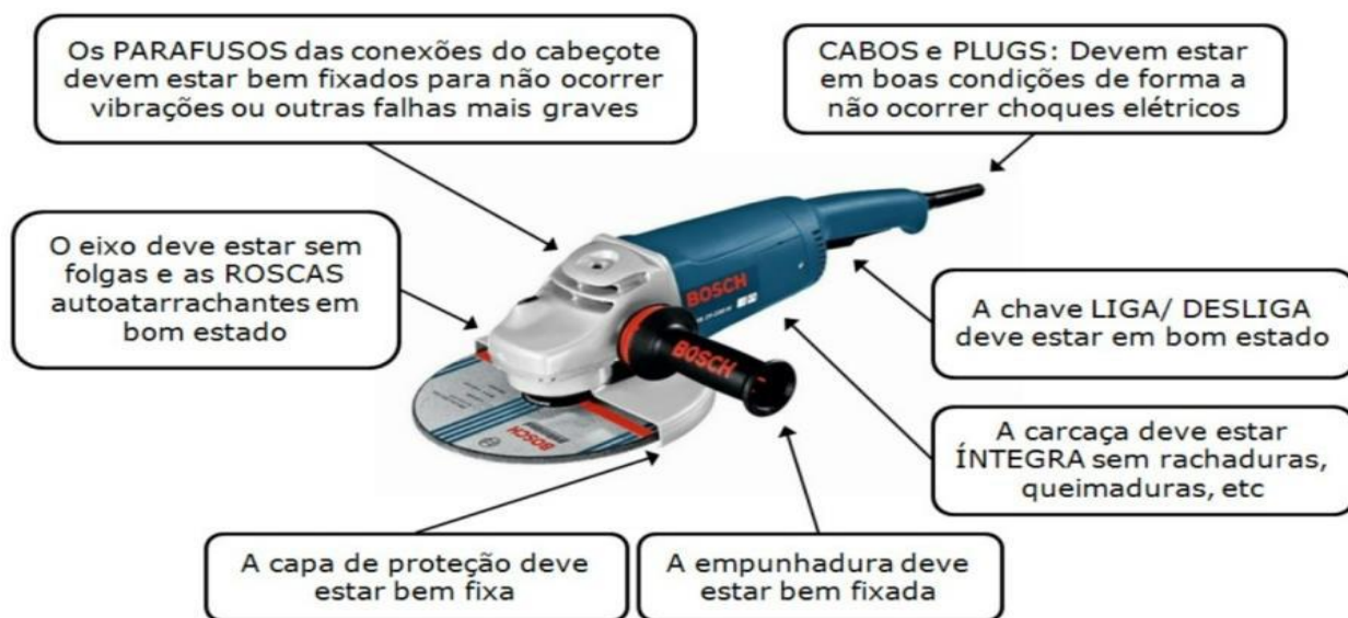
Figura 3 – Esmerilhadeira com os requisitos de funcionamento
